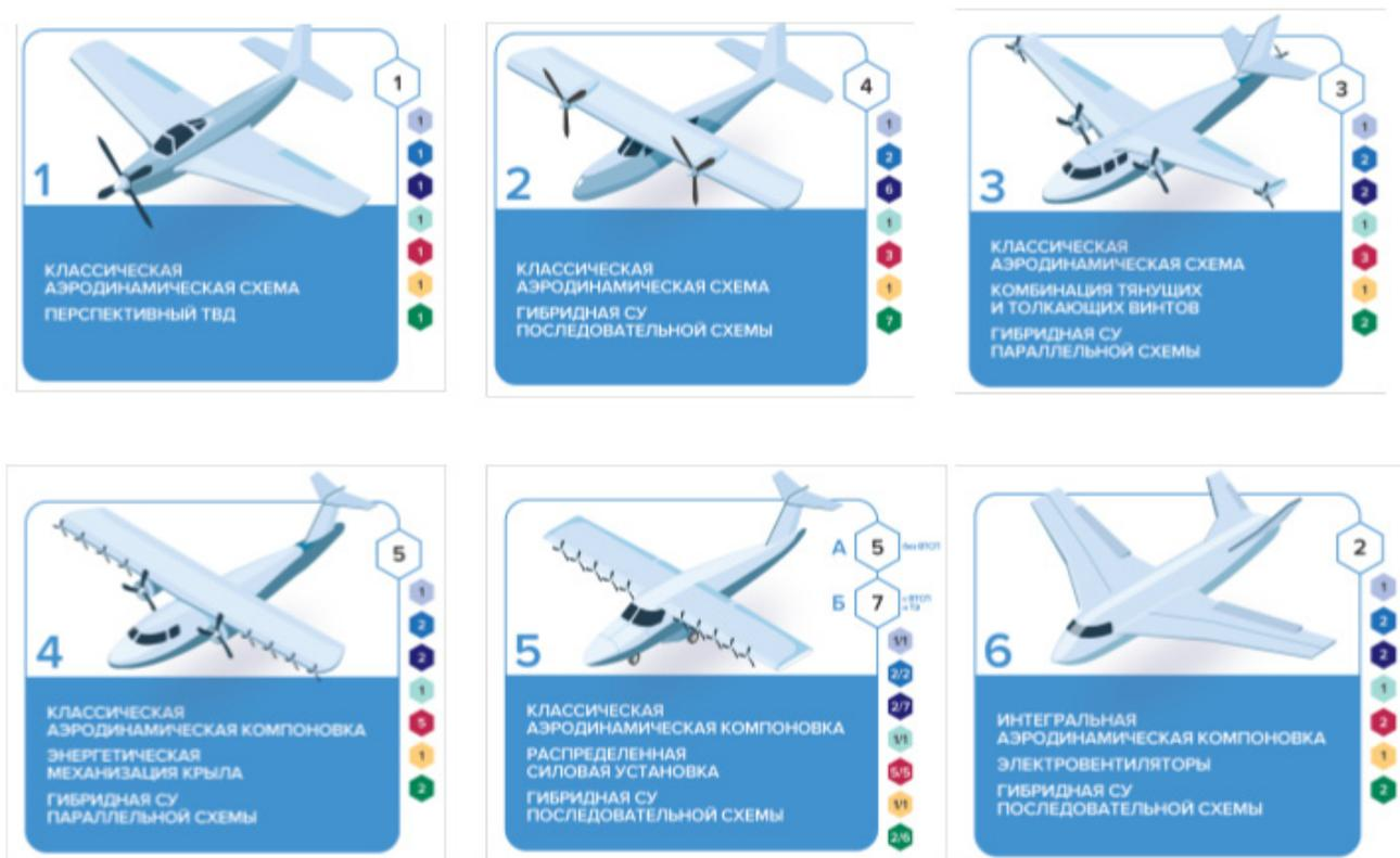
**Рис. 4.** Общий вид и основные особенности технических концепций перспективных самолетов местных воздушных линий
