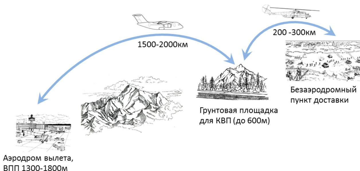
**Рис. 2.** Транспортная операция с грузом 8—12 т:
