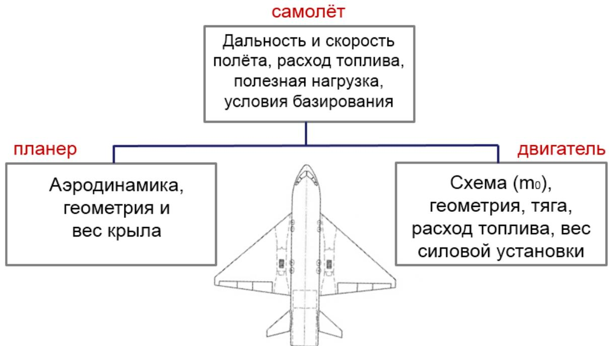
Рис. 6. Функциональная зависимость планера и двигателя
